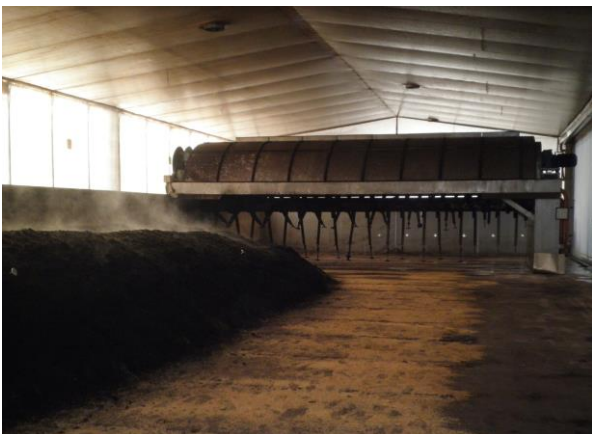
一次発酵槽ロータリー攪拌機
